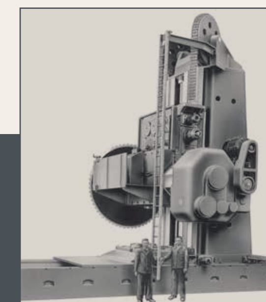
Ständer-Kaltkreissäge SKS 3000 aus dem Jahr 1938
